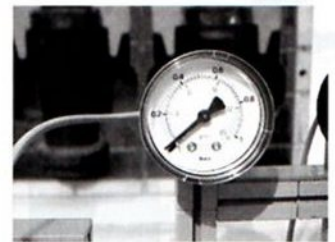
Manometer zum Messen des Luftdrucks
